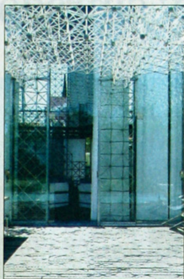
Para el piso se utilizó poliestireno expandido y una capa de cemento patinado con enduido calcáreo; para las paredes, fibrocemento
